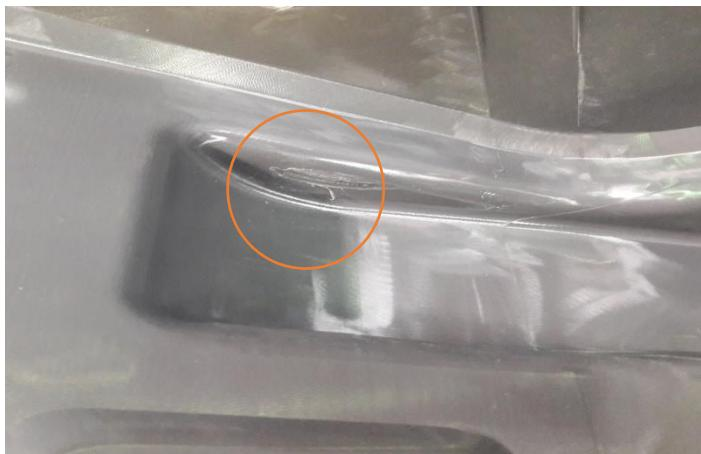
При неправильном монтаже возникает трение шкива о крышку моторного отсека
